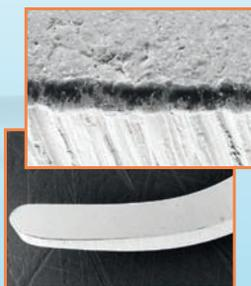
Tranchant de la curette LM Sharp Diamond™ et grossissement de l'arête après le test.
